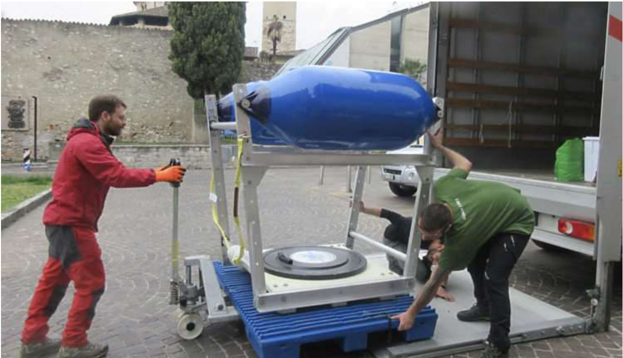
Fig. 5. Il trasduttore elettroacustico del sistema sismico a riflessione Bubble Gun HMS_LF20 utilizzato per il rilievo
