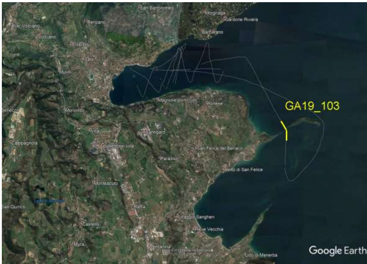
Fig. 3. In grigio, il reticolo di profili sismici acquisito durante la campagna SISGARDA2019. Il tratto evidenziato in giallo si riferisce al profilo GA1903 mostrato in Fig.6.
