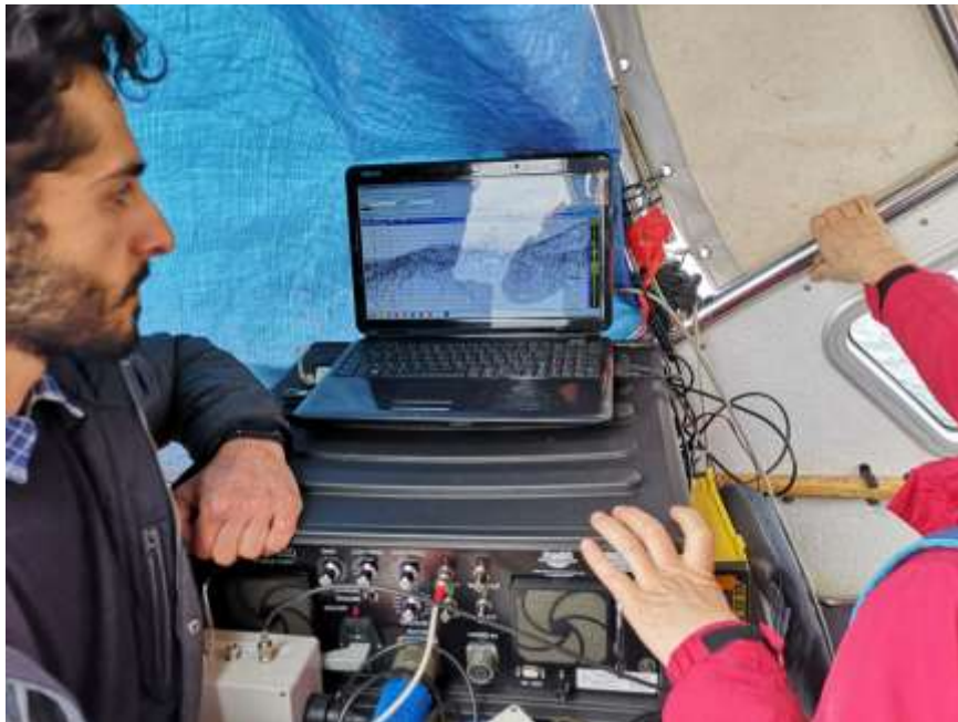
Fig. 4. La consolle di acquisizione dei dati sismici a bordo dell'imbarcazione durante la campagna SISGARDA2019
